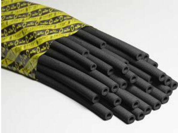
Гибкие теплоизоляционные трубки из полиэтиленовой пены специально разработаны для теплоизоляции медных трубопроводов в системах кондиционирования воздуха. Обладая закрытоячеистой структурой, материал имеет высокое сопротивление паро- и влагонепроницанию, что особенно важно при изоляции холодных поверхностей. Трубки ТИЛИТ® Блэк Стар надежно защищают от выпадения конденсата, технологичны при монтаже, стойки к агрессивным строительным материалам и механическим воздействиям, долговечны и безопасны.
